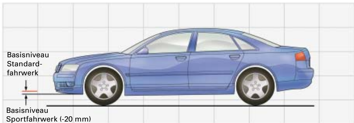
Modus „dynamic“, „automatic“ und „comfort“: Basisniveau für Sportfahrwerk
